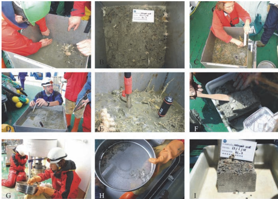
Figura 4.14. Metodología empleada con las muestras procedentes de la draga megabox corer . A. Eliminación del agua superficial. B. Fotografiado de la superficie de la muestra. C-E. Medición de potencial Redox a diferentes profundidades. F. Toma de muestra para estudios sedimentarios, concentración de hidrocarburos y metales pesados. G-H. Tamizado de la muestra. I. Sección para estudios faunísticos.
