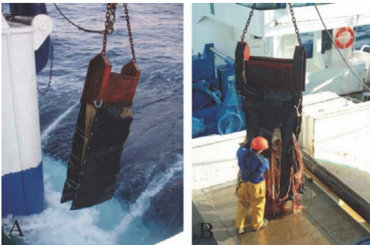
Figura 4.15. Dragas de roca. A. Protegida por goma. B. Protegida por una combinación de goma y parpaya.
