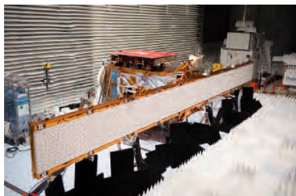
El satélite Sentinel-1a durante un test de radio frecuencia en el Thales Alenia Space en Cannes, France, 30 de enero de 2014. ESA.
