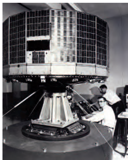
Científico realizando un test de vibración a TIROS-1 en la Astro-Electronic Products Division en Princeton. NASA.
