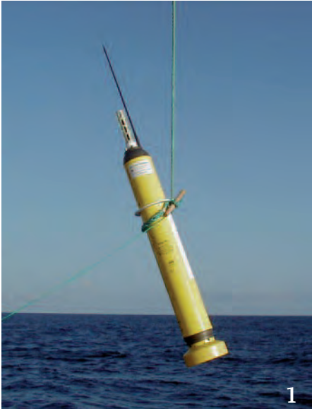
1. Despliegue de una boyo ARGO durante la campaña RAPROCAN1010. Foto: ARGO España.
