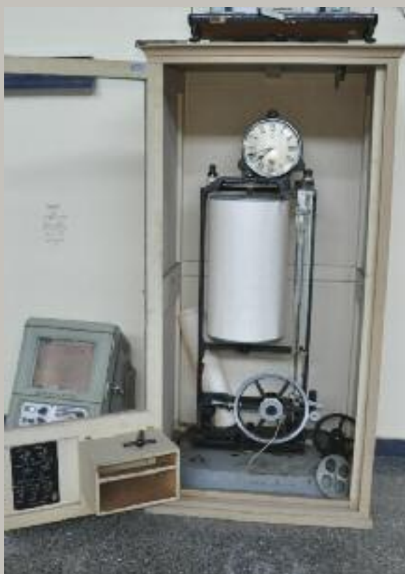
| 14 | Mareógrafo de tierra para medir el nivel del mar, instalado en el dique del Oeste de Palma de Mallorca desde 1963 hasta 1976.
