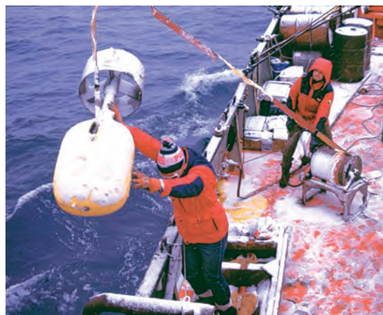
Imagen 27. Arriando el sensor del perfilador sísmico se sedimentos a bordo del Río Baker [autor: Jorge Rey Salgado].
