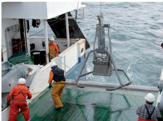
Imagen 55. Draga de fango tipo Mega box-core utilizada durante la campaña ECOMARG 2003 a bordo del B/O Vizconde de Eza (SGPM) para el estudio de las comunidades infaunales de la zona batial [autor: Francisco Sánchez].
