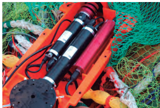
Imagen 185. Interior del sonar de red SIMRAD FS20/25, empleado en las últimas campañas de prospección acústica del IEO [autor: Juan Pérez-Rubín].
