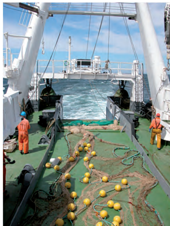
Imagen 187. Cubierta del B/O Cornide de Saavedra , con el muestreador GOC 73.
