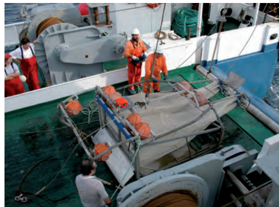
Imagen 56. Trineo modelo Arcachón dotado de redes de plancton utilizado durante la campaña ECOMARG 2003 a bordo del B/O Vizconde de Eza (SGPM) para el estudio de las comunidades suprabentónicas de la zona batial [autor: Francisco Sánchez].
