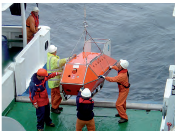
Imagen 57. El trineo fotogramétrico TFS-2, diseñado y patentado en el CO de Santander del IEO, fue utilizado para la obtención de imágenes submarinas en los hábitats batiales vulnerables durante las campañas ECOMARG [autor: Francisco Sánchez].
