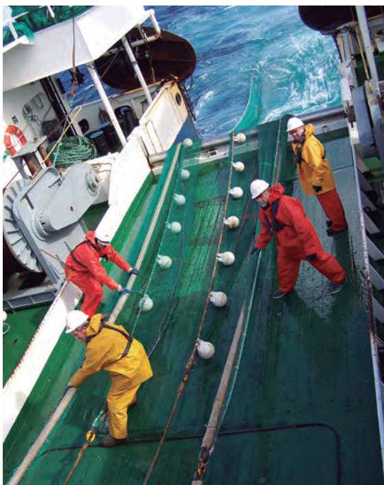
Imagen 9. Operaciones a bordo en el B/O Vizconde de Eza con arte de arrastre de fondo en el banco de Porcupine [autora: Isabel Bruno].
