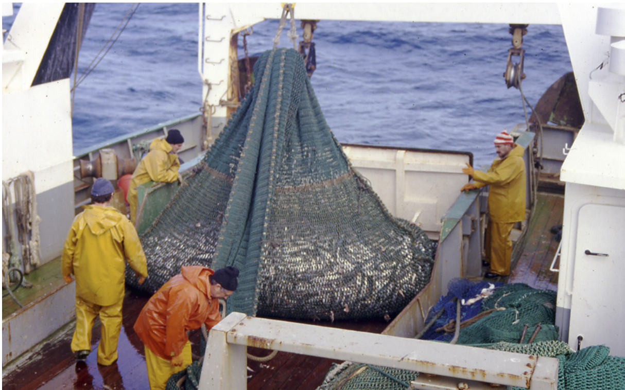
FIGURA 1.1. Virado y vaciado del arte de pesca en un arrastrero de fondo
