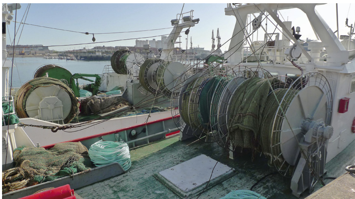
FIGURA 3.7. Arte de arrastre tipo "jurelera" estibado a bordo
