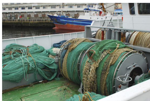
FIGURA 3.3. Arte de arrastre de fondo con puertas estibada a bordo
